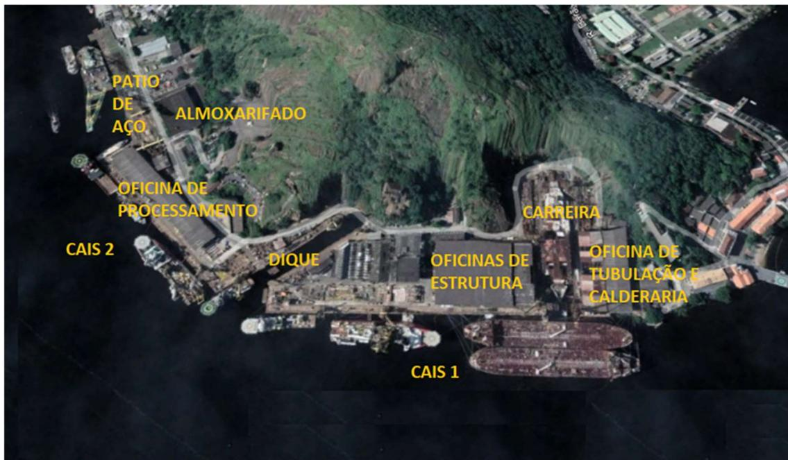
Layout do estaleiro com indicação detalhada das áreas do estaleiro, destacando as oficinas cobertas, almoxarifado central, carreira de lançamento e áreas de acostagem no cais
